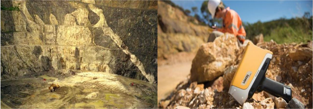
Abbildung 1: Links: LCT-Pegmatitlagerstätte Greenbushes (Li, Ta, Sn) in Westaustralien. Rechts: Vanta RFA-Handanalysator bei der geochemischen Exploration von Mineralien.
